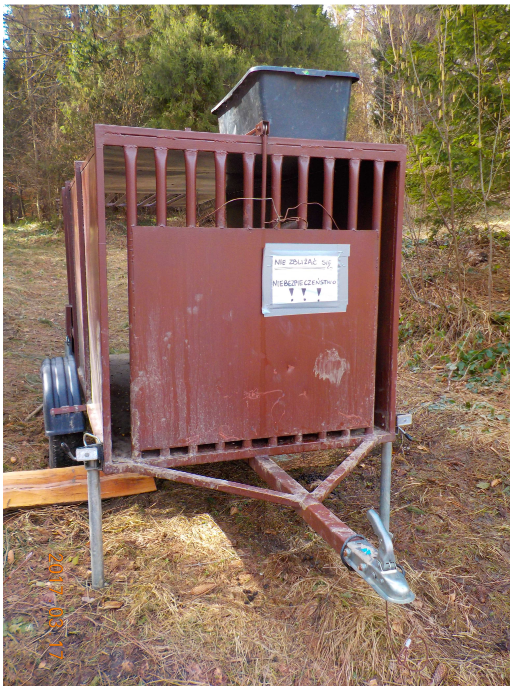
Rysunek 1. Dyszel z profili zamkniętych w kształcie litery V z zaczepem kulowym oraz burta przednia wysoka z otworami wentylacyjnymi.
