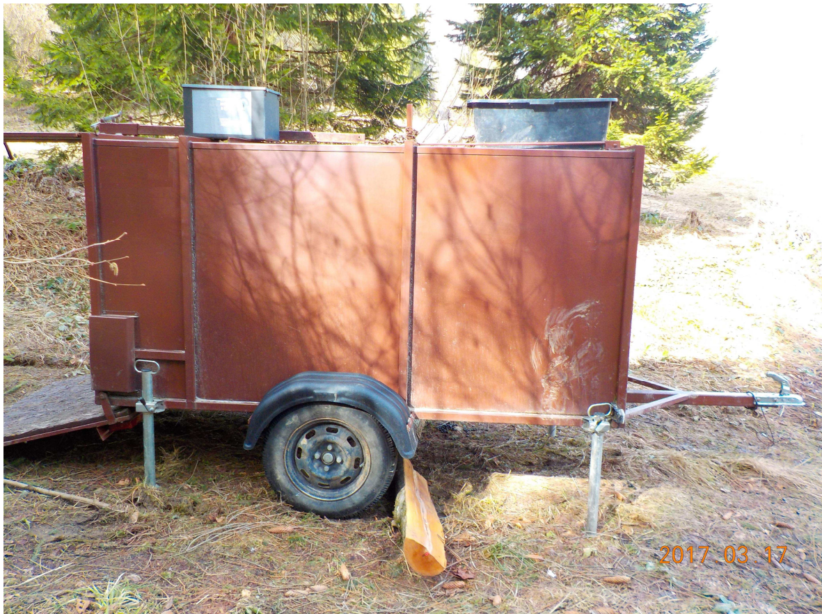
Rysunek 2. Ściana boczna z podporami stabilizującymi rurowymi.
