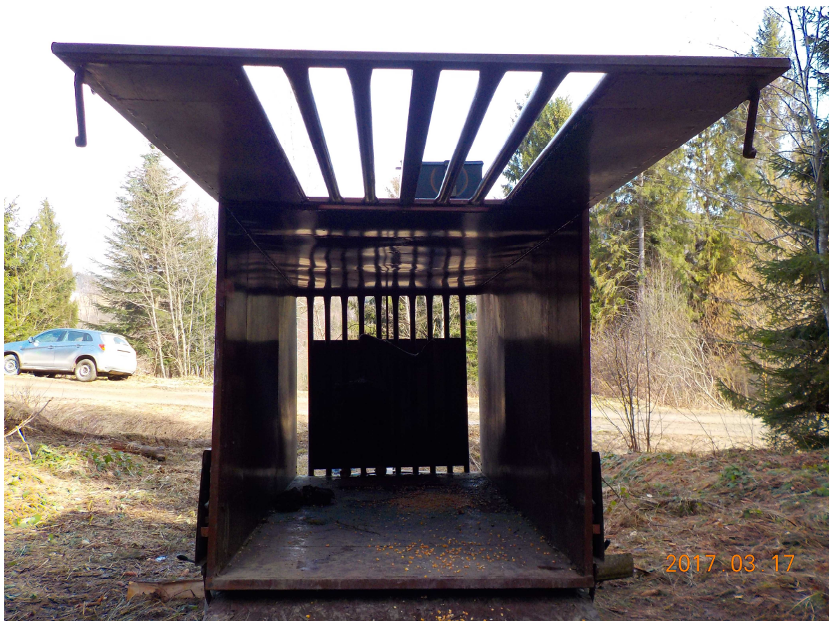
Rysunek 3. Burta tylna otwierana do góry z otworami wentylacyjnymi.
