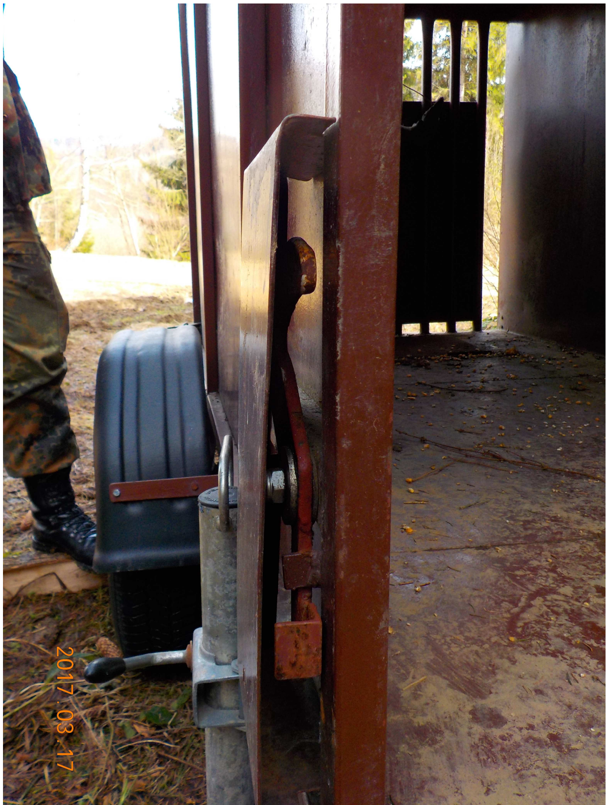
Rysunek 6. Mechanizm zatrzaskowy zamykający burtę tylną
