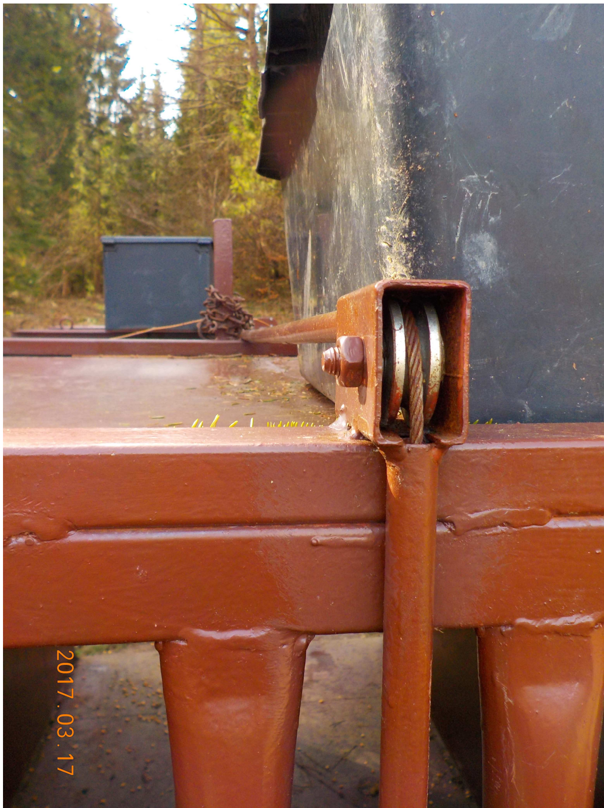
Rysunek 8. Linka na rolkach z zabudową chroniącą przed czynnikami zewnętrznymi.
