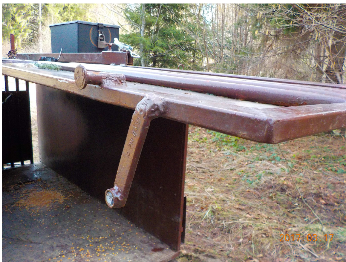
Rysunek 5. Burta tylna z mechanizmem zamykającym zatrzaskowym
